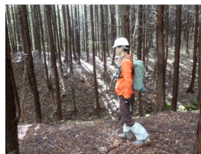
自己位置推定検出器（モリナビ）を用いた森林内の放射線測定
