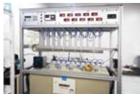
電解濃縮装置
