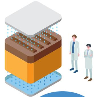
除染によって回収された土に雨が降ったときの影響を実験室でシミュレーションしています。
