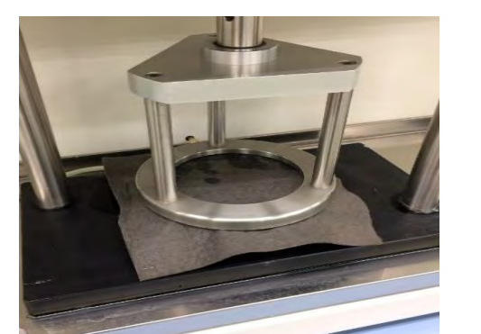
上部遮水シート等の耐水度試験
