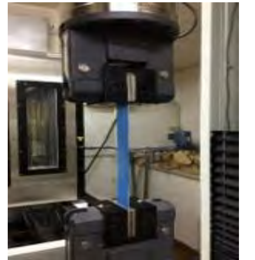
保管容器生地の引張強度試験 (JIS Z 1651)
