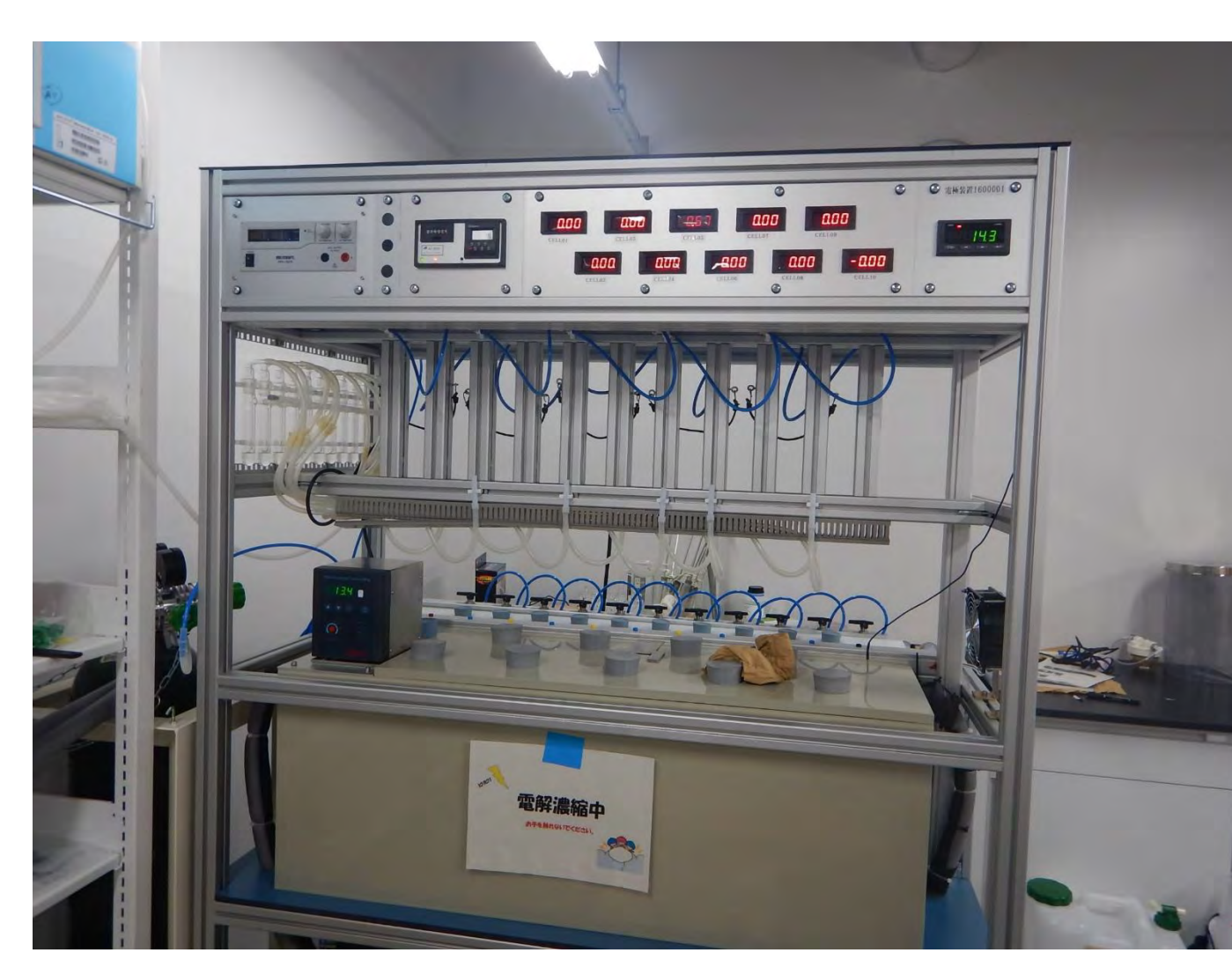
トリチウム電解濃縮装置
