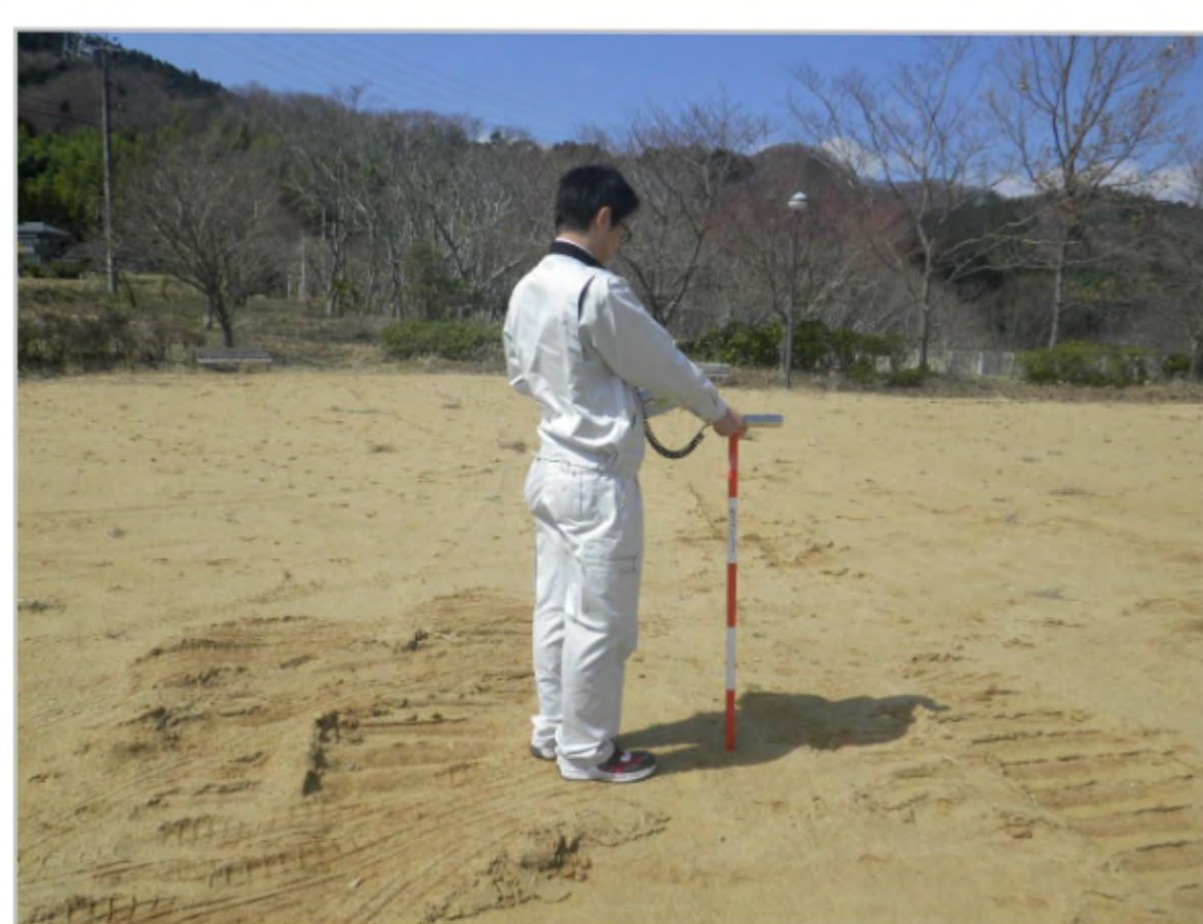
サーベイメータによる測定
