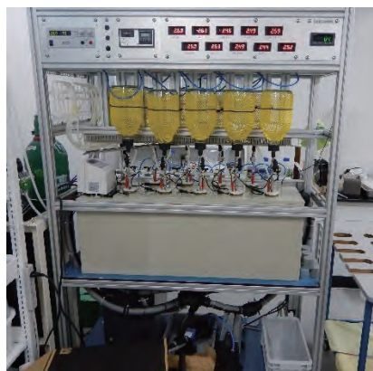
図1 電解濃縮装置外観
