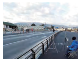
騒音計の設置
