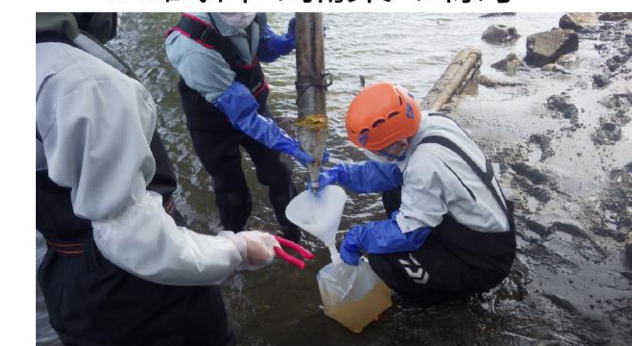
SS試料の捕集の様子
