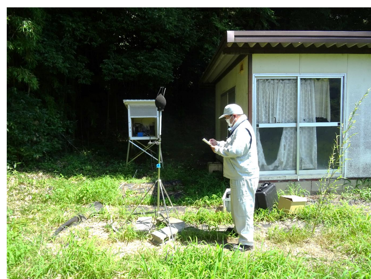
騒音計の設置
