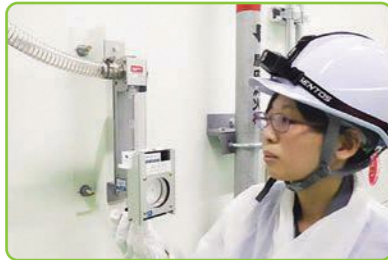
作業場所における放射性物質濃度測定
