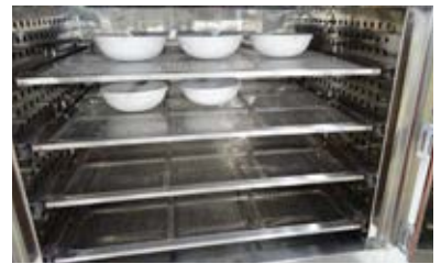
試料を灰化炉で処理
