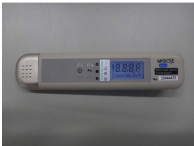
個人被ばく線量計 (電子式ポケット線量計、ガンマ線用) 男性は胸部に、女性は腹部に液晶面を体側に向けて装着します。
